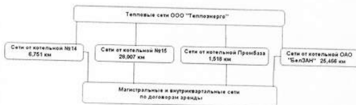
Рисунок 1.6 - Структура тепловых сетей ООО «Теплоэнерго»
